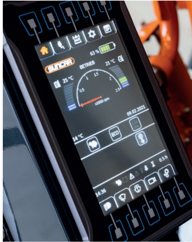
Der Multifunktionsmonitor wird über den ergonomisch platzierten Smart Control (Dreh-Drück-Knopf) betätigt.
